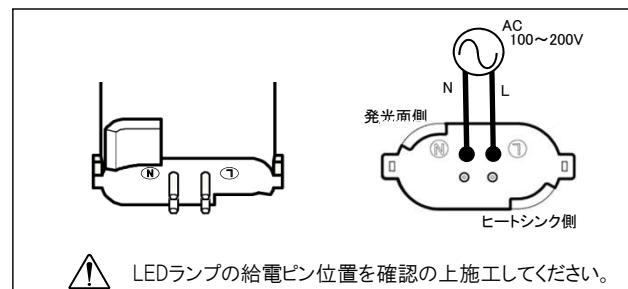
⚠️ LEDランプの給電ピン位置を確認の上施工してください。
